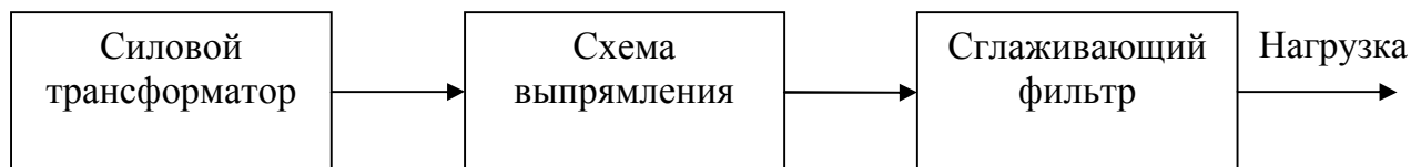
Рис. 1. Структурная схема выпрямителя
